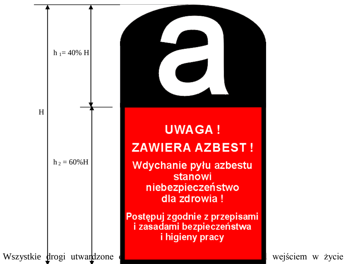
Rys. 1 Wzór oznakowania instalacji lub urządzeń zawierających azbest oraz rur azbestowo -cementowych.
