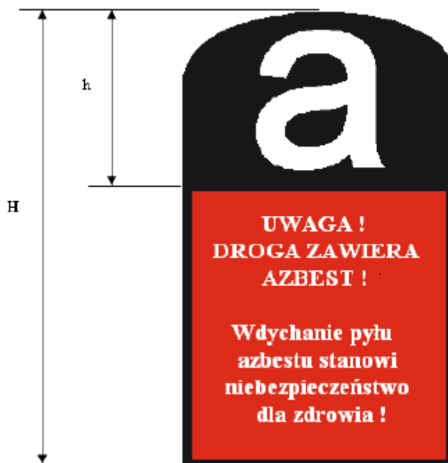
Rys. 2 Wzór oznakowania dróg utwardzonych odpadami zawierającymi azbest przed wejściem w życie ustawy z dnia 19 czerwca 1997 r. o zakazie stosowania wyrobów zawierających azbest, ale niezabezpieczonych trwale przed emisją włókien azbestu.
